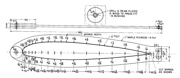
Fig. 85 Aileron Contour Jig
