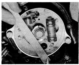
Fig. 15. Magneto Breaker Point Adjustment (Bosch)
