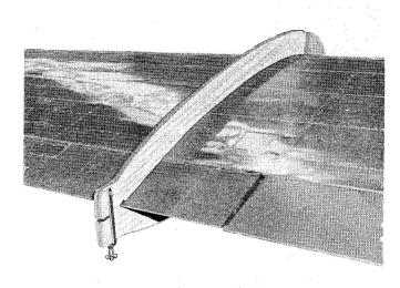
Fig. 58 Aileron Contour Jig
