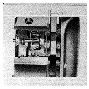
Fig. 45 Determining Lining Wear
